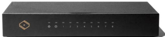
Der über 8 Gigabit Ethernet Ports verfügende N8 ist vereinfacht gesagt so konzipiert, dass im Vergleich zu einem Standardswitch keine Datenverluste entstehen und ein qualitativ deutlich besseres Netzwerksignal ausgegeben wird, so dass angeschlossene Netzwerkgeräte wie Audiostreamer unter bestmöglichen Bedingungen arbeiten können.
